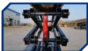
安全检修支架
